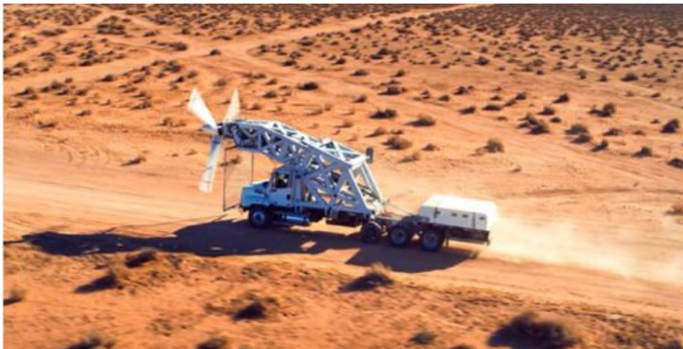
[그림 Ⅲ-2] 버터플라이의 전기추진 시스템 지상 시험
