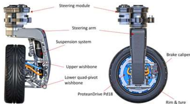
<Protean Electric의 모델 장착도, 출처: Protean Electric>
